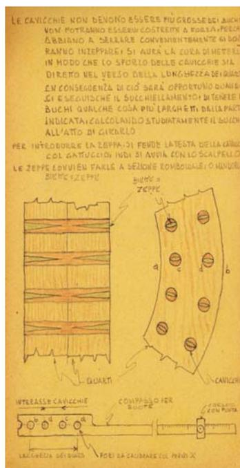
Figura 14. Appunti per la messa in opera di cavicchi e zeppe.
