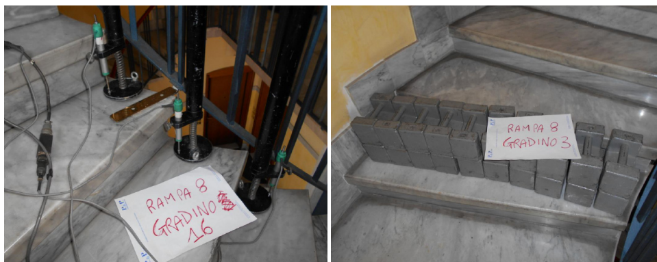
Figura 6. Strumentazione utilizzata per le prove di carico.
