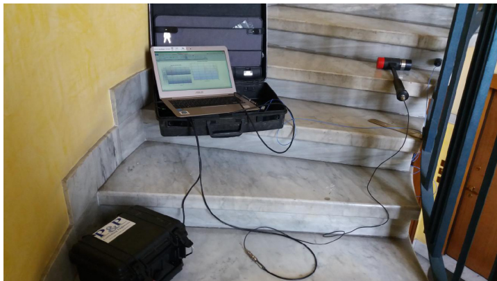
Figura 5. Strumentazione utilizzata per le prove dinamiche.
